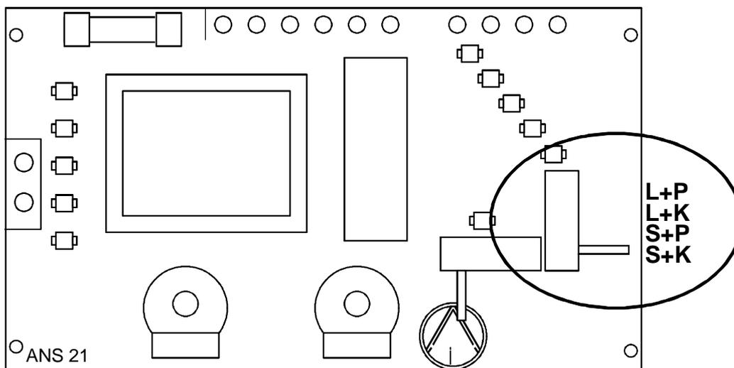
Die Wahl erfolgt über einen Schiebeschalter am rechten Rand der Platine. Auf den Schiebeschalter kann von außen nicht zugegriffen werden.
