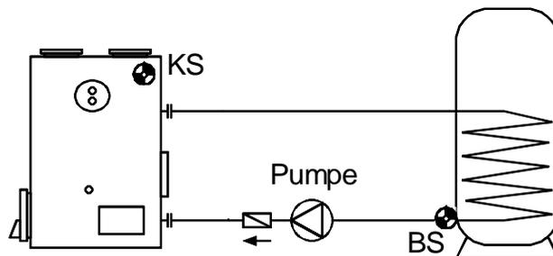
Die Pumpe läuft, wenn Sensor **KS** größer als die Schwelle **max** ist (hier als „min“ verwendet) und Sensor **KS** um die Differenz **diff** höher ist als Sensor **BS**.
