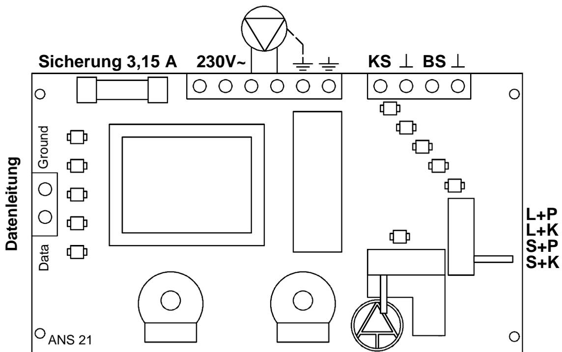
Bei Anwendung der Master-Slave-Funktion muss die Datenleitung **phasengleich** an beiden Geräten angeschlossen werden (Data auf Data, Ground auf Ground).
