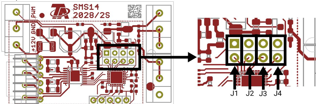
Die Position der Jumper wird nur beim Start (= Anlegen der Spannung) ausgelesen. Werden die Jumper also bei laufendem Betrieb geändert, werden die neuen Jumperstellung erst nach einem Neustart übernommen.
