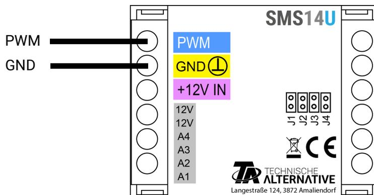
Das PWM-Signal wird von 5% bis 95% linear ausgewertet.
