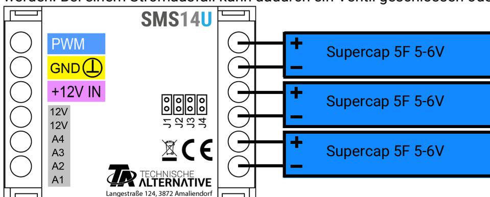
Bei Stromausfall und angeschlossenen Superkondensatoren fährt die SMS auf 0% Motorposition laut Definition mittels Jumper J4.
